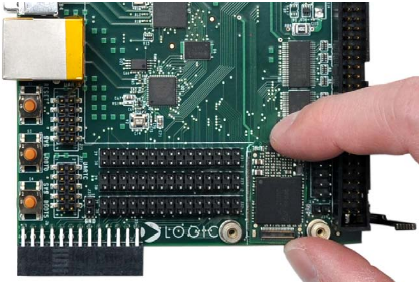
Figure 2.2 – Align the SOM over the Baseboard
